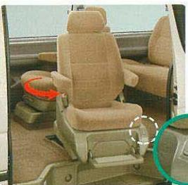
シートスイッチ操作により、シートが左へ回転(76°)すると同時に、前方へスライドします。
