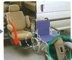
シートロック解除レバーを押し下げシートを左へ手動回転(90°)させます。
