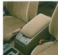
ファブリック巻き・収納式カップホルダー付フロント大型コンソールボックス（アームレストタイプ）
