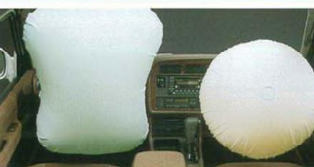
デュアルSRSエアバッグ\* シートベルトを補助する装置です。必ずシートベルトをご着用ください。デュアルSRSエアバッグは、万一の衝突の際、前方からの強い衝撃に対して作動し、シートベルトの働きと合わせ、前席乗員の頭や胸の重大な傷害を軽減します。なお、SRSエアバッグは衝突時の衝撃が弱い場合は作動しません。
