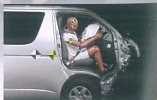
実験用車両でオフセット前面衝突実験
