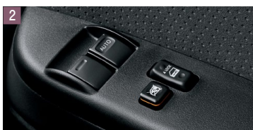
■パワーウィンドウ（運転席・助手席） 【運転席/キーOFF後作動可能ワンタッチ式・挟み込み防止機能付】
